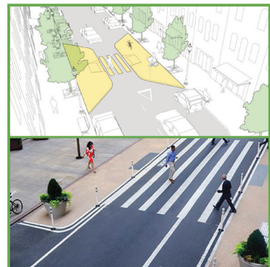
Estrechamiento de calzada
