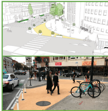
Eliminación de carril de giro
